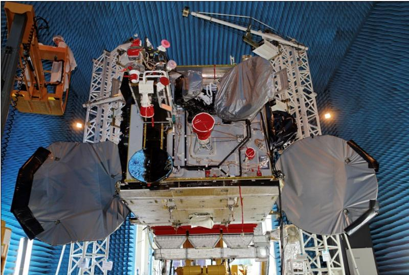
Рис. 9.5. Антенная система КА «Ямал-300К»
