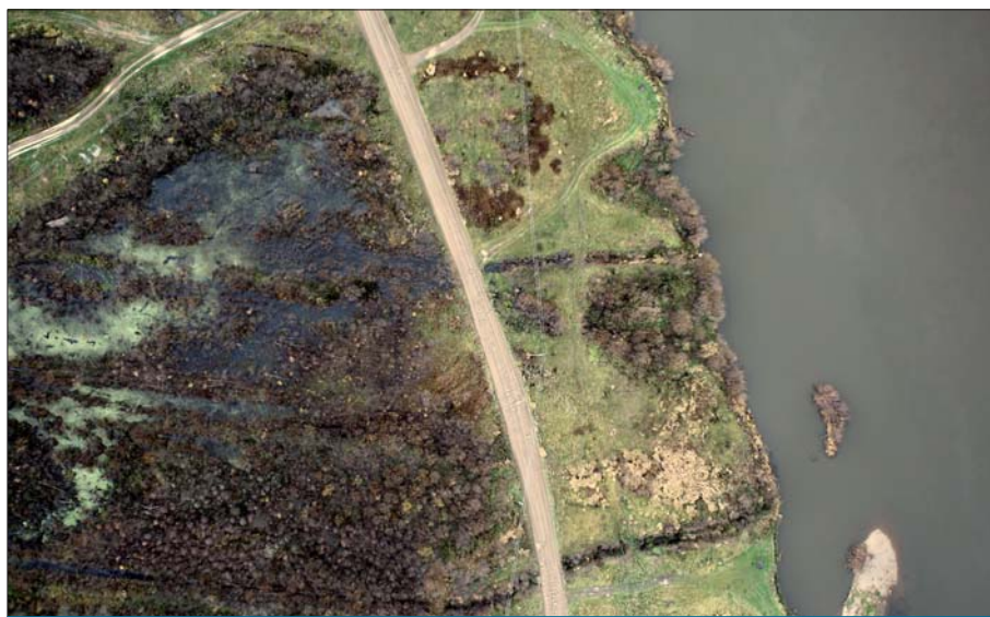
Рис. 6. Пример «сырого» беспилотного снимка трассы МГ. Пересечение трассы МГ с рекой. Участок с повышенным обводнением
