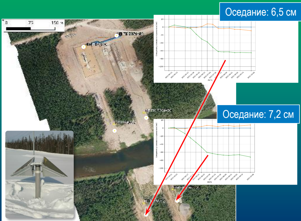
Фиксация оседания до 7,2 см на склоне реки Амга
