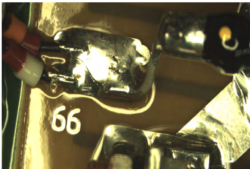
Рис. 8.7. Излом поверхности пайки
