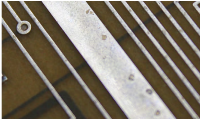
Рис. 8.8. Дефект металлизации печатной платы
