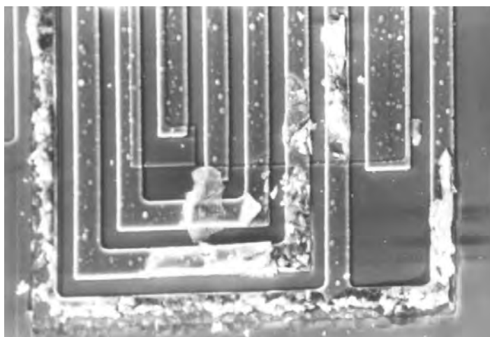
Внешний вид коррозионных разрушений шин металлизации
