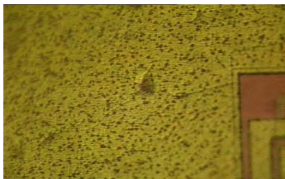
Рис. 8.3. Растрескивание и отслаивание металлизации ИС
