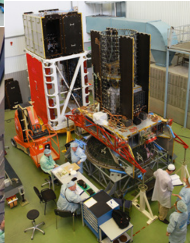
Конструкция БРК КА «Ямал-401» на заводе Thales Alenia Space, Франция, 2012 год
