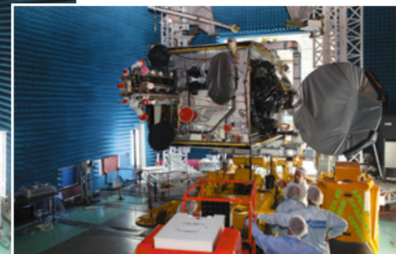
Безэховая камера. Раскрытие антенн. Подготовка к испытаниям ретранслятора БРК в безэховой камере. ОАО «ИСС», г. Железногорск, 2012 год
