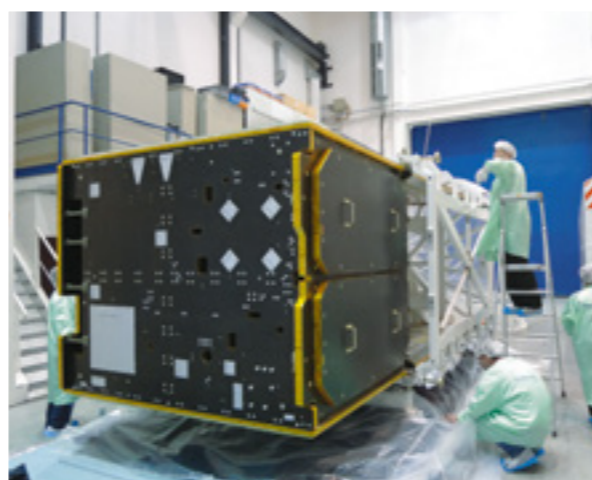
Выгрузка конструкции полезной нагрузки КА «Ямал-401» из жесткого корсета
