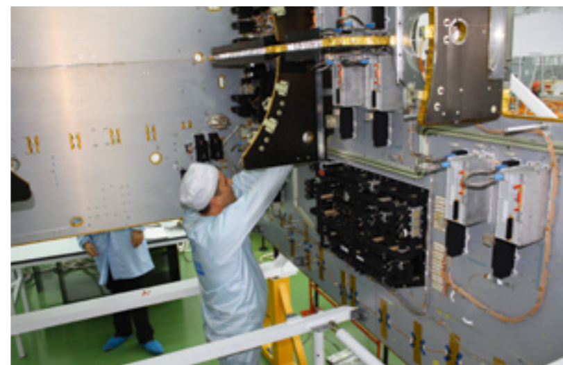
Сборка полезной нагрузки КА «Ямал-300К». ОАО «ИСС», г. Железнодорожск
