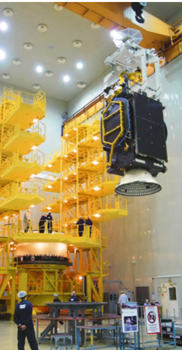
Установка космического аппарата на разгонный блок. Монтажно-испытательный корпус. Космодром Байконур
