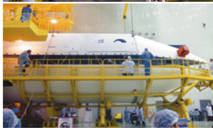
Установка створки головного обтекателя. Монтажно-испытательный корпус. Космодром Байконур
