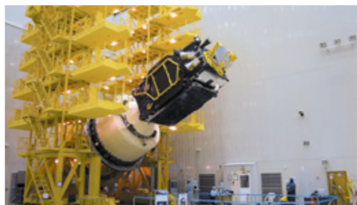
Кантование космического аппарата с разгонным блоком. Монтажно-испытательный корпус. Космодром Байконур
