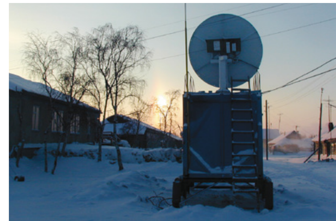
Передвижная станция спутниковой связи в контейнерном исполнении, Нори
