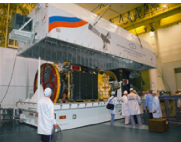
Снятие крышки транспортного контейнера в монтажно-испытательном корпусе, космодром Байконур
