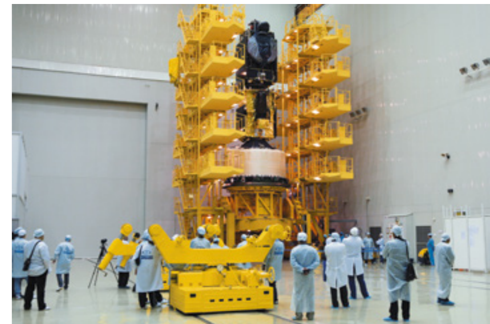
Космическая головная часть в стапеле. Монтажно-испытательный корпус, космодром Байконур, 2012 год
