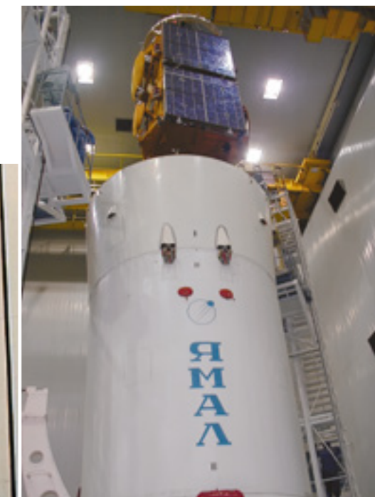
Установка блока КА «Ямал-100» на разгонный блок
