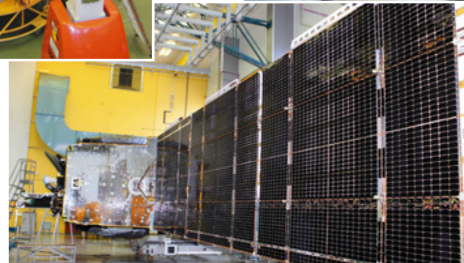
Раскрытие крыла солнечной батареи КА «Ямал-300К». ОАО «ИСС», г. Железнодорожск, 2012 год
