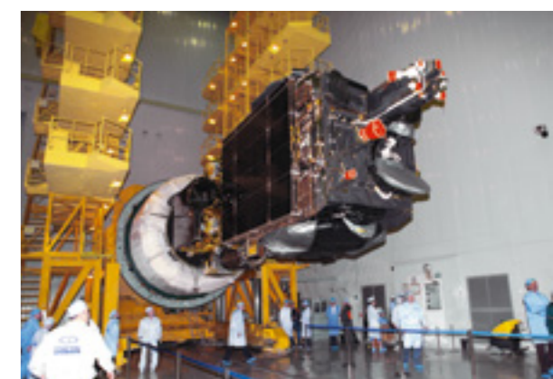
Подготовка космической головной части к накатке головного обтекателя
