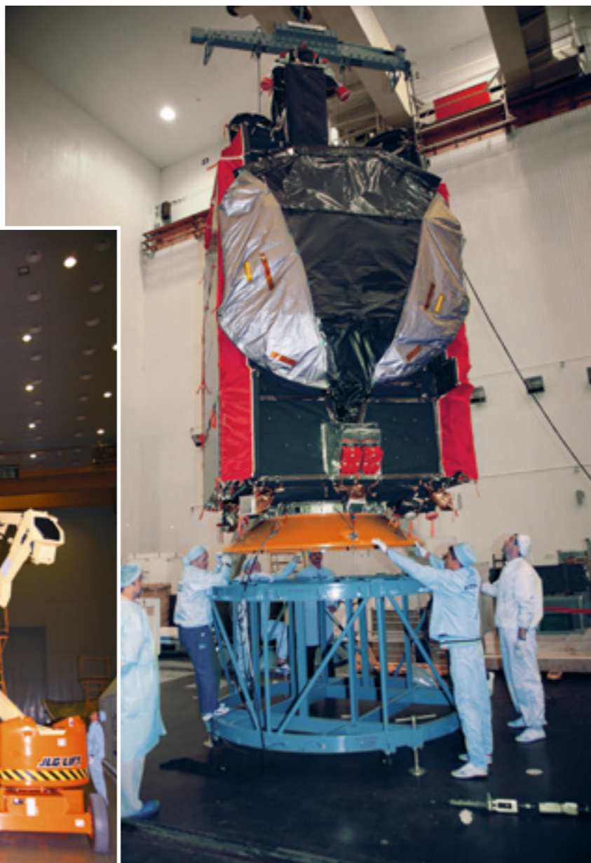
Снятие крышки транспортного контейнера в монтажно-испытательном корпусе, космодром Байконур
