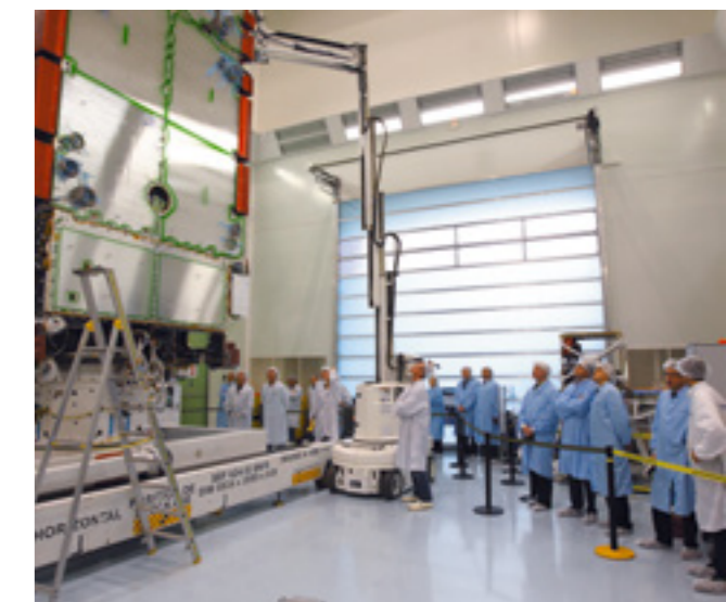
Осмотр КА «Ямал-402» после монтажа модуля полезной нагрузки и платформы. Thales Alenia Space, Франция
