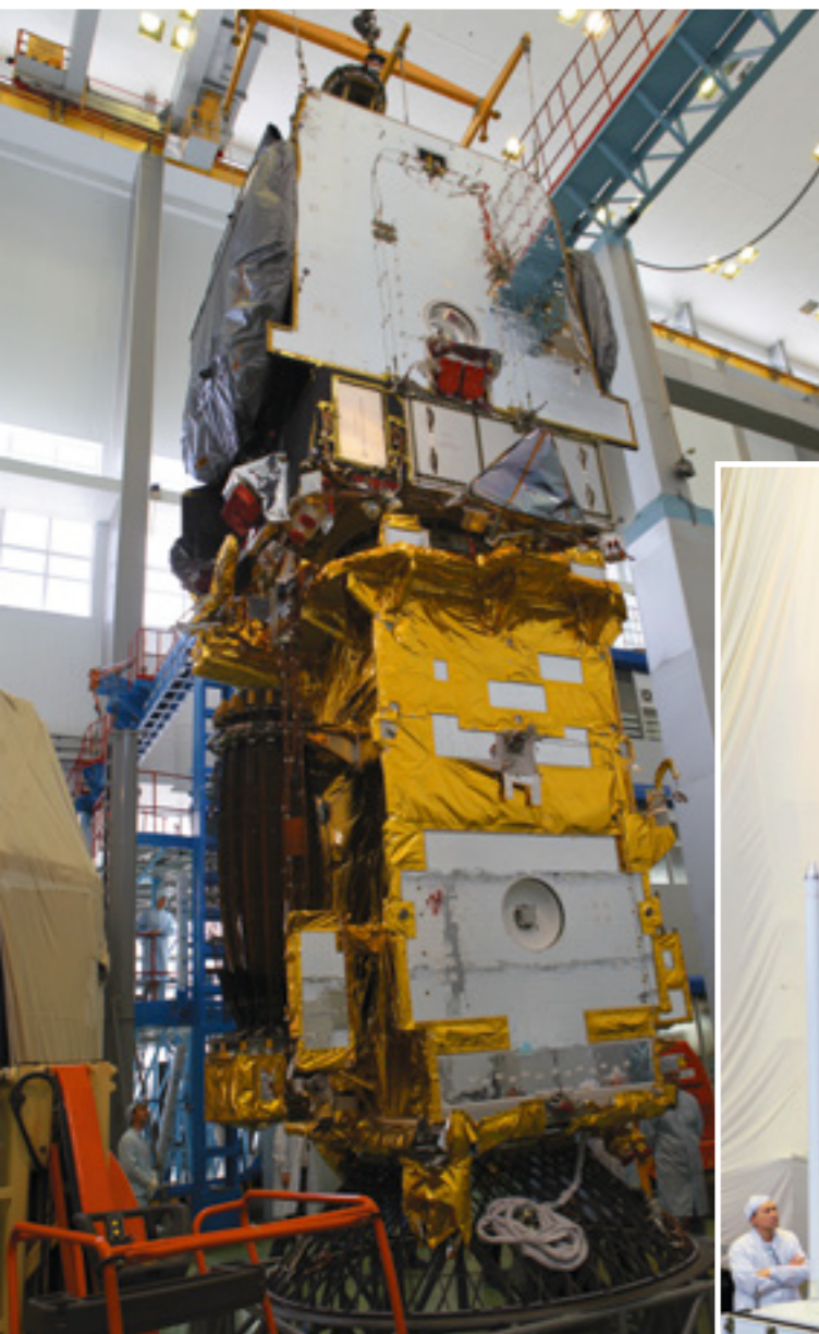
Стыковка КА «Ямал-300К» с КА «Луч-5Б»
