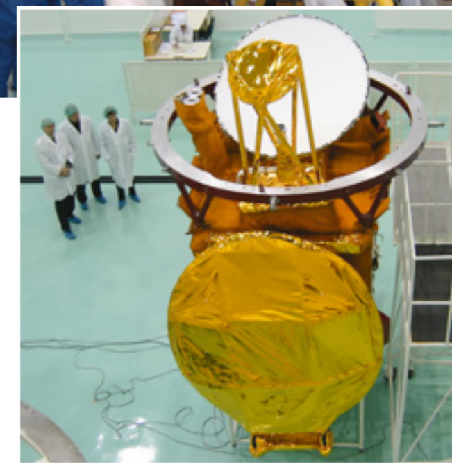
Подготовка КА «Ямал-201» и «Ямал-202» к совместным электрическим проверкам
