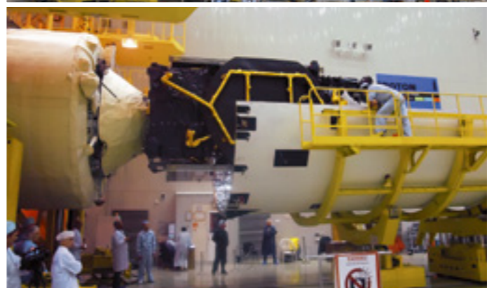
Накатка створки головного обтекателя. Монтажно-испытательный корпус. Космодром Байконур
