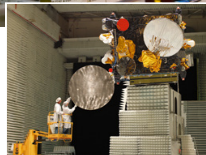
Испытания КА «Ямал-402» на электромагнитную совместимость
