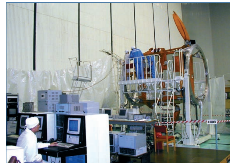
В.И.Верхотуров при проведении стыковочных электрических испытаний
